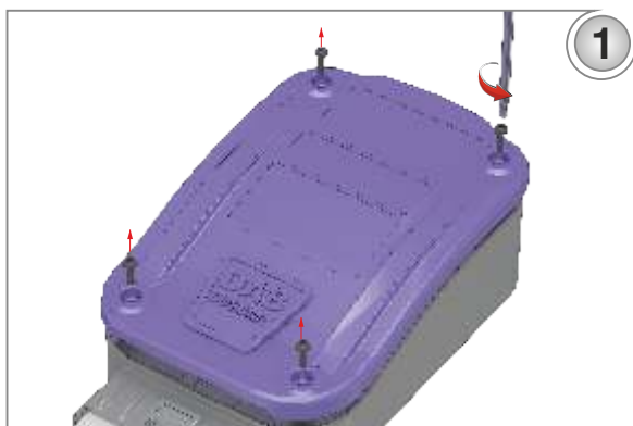
1- Используя отвертку, открутите шурупы питающего модуля.
