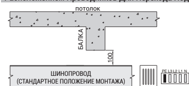
Рисунок 4 - Применение Шинпровода С Поперечным Расположением Проводников Для Перехода Под Балкой
