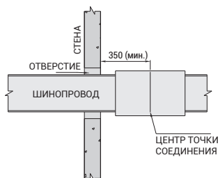
Рисунок 7 - Пересечение Стандартной Стены
