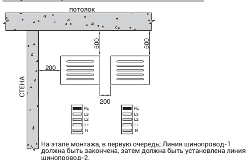
Рисунок 4 - Применение Шинпровода С Поперечным Расположением Проводников Для Перехода Под Балкой
